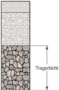
Lage der Tragschicht im Asphaltobertbau.
